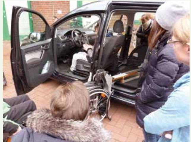
Innerhalb der **spina bifida-Woche** wurden gerade für die heranwachsenden Gäste interessante Autos vorgeführt, die auch durch Rolli-Fahrer genutzt werden können. Ein VW Bulli ist seitlich mit einem Lift ausgestattet, der auf Knopfdruck auf der Fernbedienung die Laderampe ausfährt, den Rolli-Fahrer ins Auto transportiert und wieder einfährt. Bei einem VW Caddy konnte ein Transportwagen ebenfalls seitlich ausgefahren werden, um den Rollstuhl ins Auto und auch wieder raus zu hieven.
